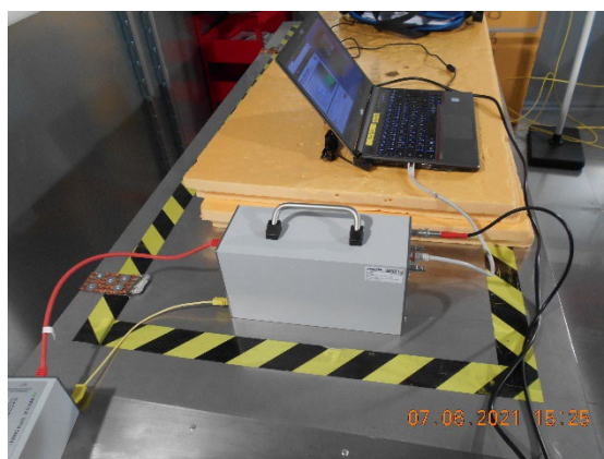
Abbildung 24: Surgeprüfung auf ungeschirmte Ethernetkabel. Oben: der normative Aufbau des Koppelnetzes nach DIN EN 61000-4-5:2014+A1:2017; Unten: die Umsetzung des Aufbaus mit Highspeed Koppel-Entkoppelnetzwerk und zusätzlichem Schutzfilter für die Hilfseinrichtung
