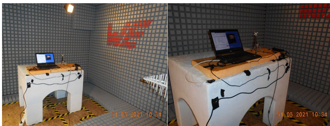
Abbildung 14: Aufbau der Störfestigkeitsprüfung gegen elektromagnetische Felder des Notebooks
