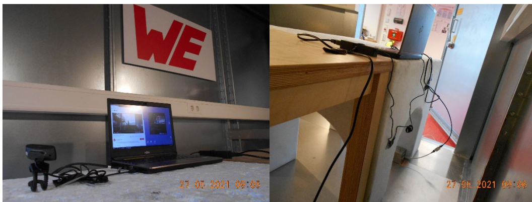
Abbildung 3: Aufbau der leitungsgeführten Störaussendungsprüfung des Prüflings. Verwendung eines geschirmten Ethernetkabels
