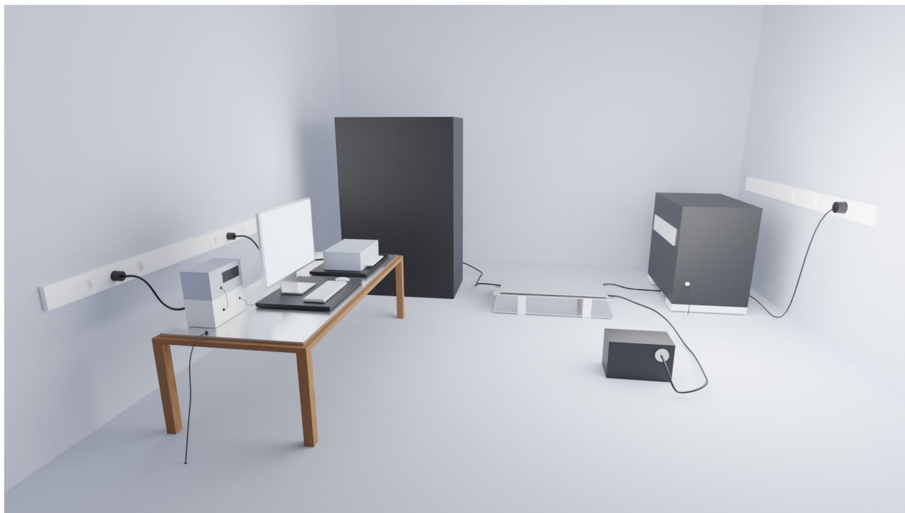
Abbildung 19: Aufbau der Burstprüfung nach DIN EN 61000-4-4:2013-04
