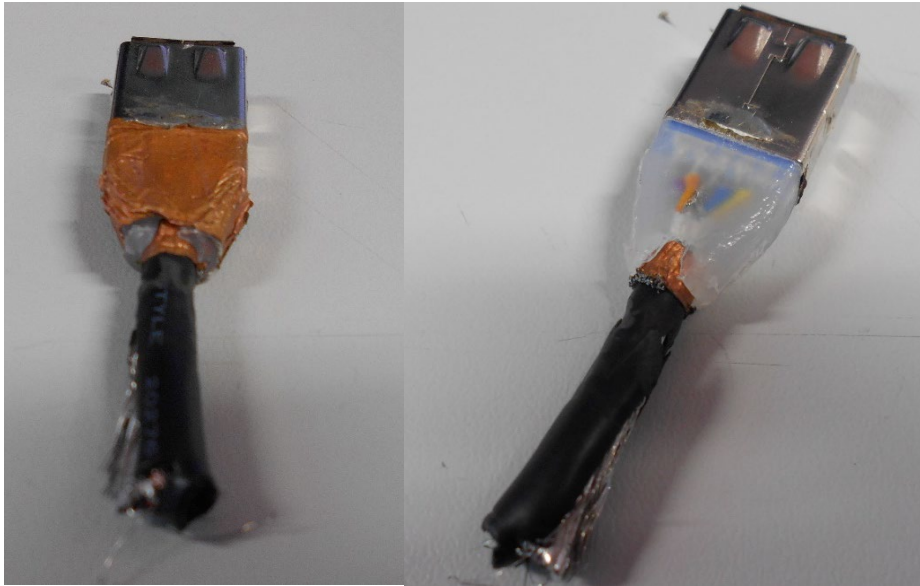
Abbildung 1: USB-Kabel mit nicht vollflächig geschlossenem Schirm. Der Schlitz zwischen dem äußeren Kupferklebeband und dem inneren Schirmgeflecht (linkes Bild) unterbricht den Schirm
